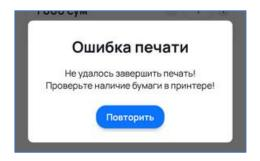
Работа с онлайн ККМ будет прервана в результате отсутствия или замятия чековой ленты, а также неисправности в работе принтера.
